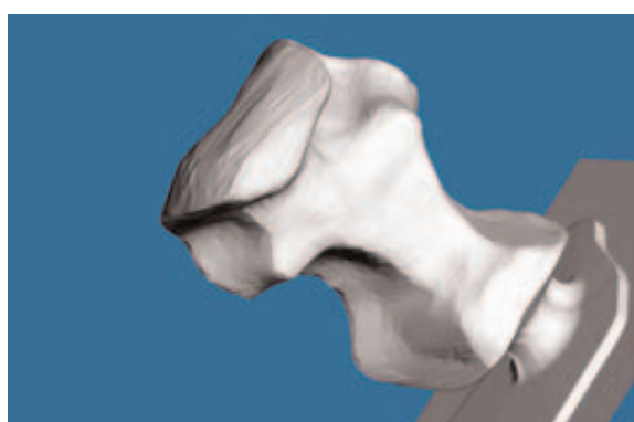
Abb. 8: Fräsvorschau im CAM-Programm. Die substraktive Fertigungstechnik von individuellen Einzelanfertigungen führt technologiebedingt zu Passungen, die nicht direkt mit gegossenen Versorgungen vergleichbar sind.
