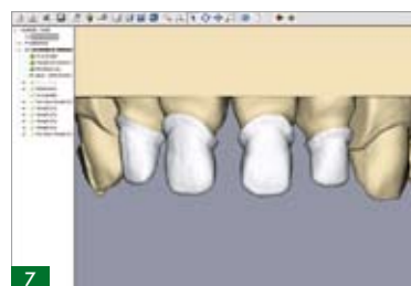
Abb. 7: Die fertig modellierten Käppchen nach der manuellen Nachbearbeitung zur Gerüstunterstützung. Die Daten sind versandfertig.
