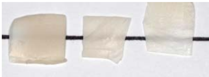
Abb. 21 Plättchen aus gesintertem Zirkondioxid in den Schichtstärken von 0,8, 0,5 und 0,3 mm. Die deutliche Zunahme der Transluzenz bei abnehmender Dicke ist deutlich zu erkennen. Diese Proben sind manuell hergestellt (ZirkonZahn Deutschland, Neuler) und geben daher nur ungefähre Größenordnungen wieder.
